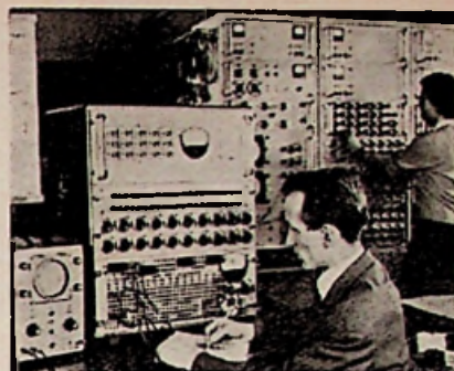
Deze laboratorium-opname toont op de voorgrond de vol-transistor tafel-analoog-rekenmachine RAT 700.
